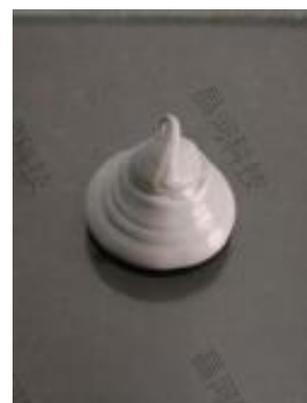
图 2.1-6 CR TM-SGrease-1250N 点堆外观
